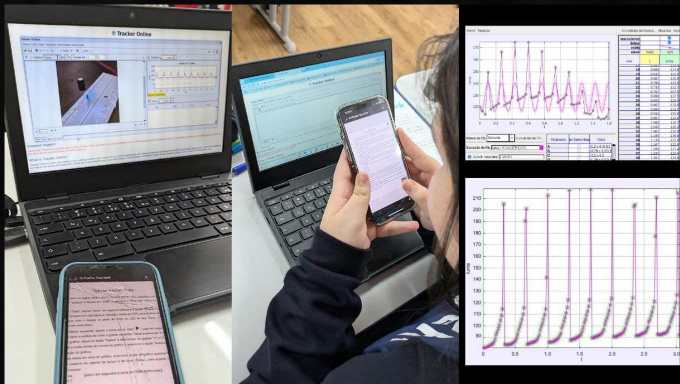
Figura 39 - Realização do Momento 5 em sala de aula. Análise dos vídeos capturados com o smartphone pelos estudantes através do software livre Tracker Online. Gráficos de tempo x brilho do LED, gerados pelos estudantes.
