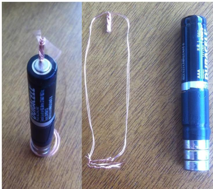
Figura 9 - Motor elétrico simples - imagem própria
