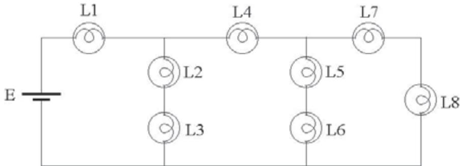
Sendo  $E = 220 \text{ V}$  e a resistência elétrica de cada lâmpada de  $55 \Omega$ , Qual é a intensidade de corrente que atravessa as lâmpadas L1 e L8 respectivamente?
