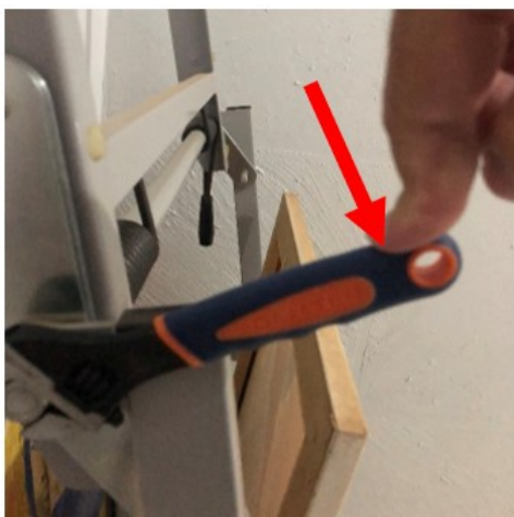
Figura 3.8 – Aplicação de força na extremidade da chave. Fonte: Elaboração própria (2021).
