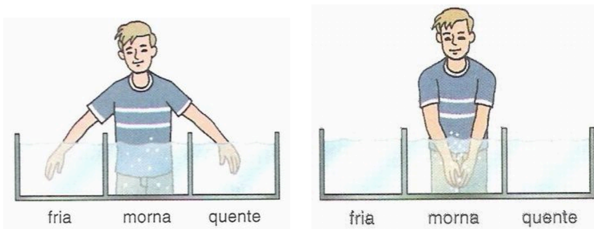
Imagem 4 - Experimento mental para ilustrar a falha na percepção sensorial como instrumento de medida
